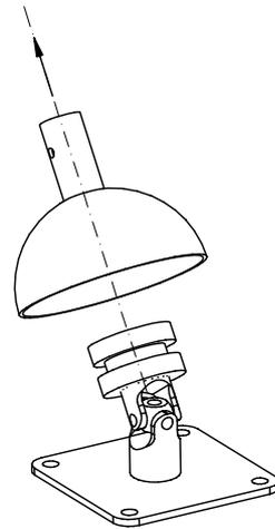
**6. Neue Fußplatte inkl. Kardangeln und Kugellager mit Lageroberteil zusammensetzen.**
