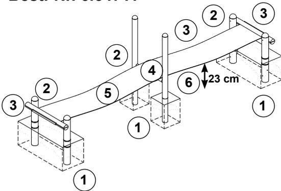
Falls das Durchhangbild nicht gleichmäßig ist, kann durch Einsetzen von Unterscheiben Ø 68 mm (**Detail A**) zwischen Standpfosten und Querbäumen an der Seite mit dem größeren Durchhang Abhilfe geschaffen werden. Ebenso ist es möglich, an der zu straff gespannten Seite durch Abhobeln der Kontaktstelle zwischen Standpfosten und Querbäumen (**Detail B**) einen Durchhangausgleich zu schaffen.
